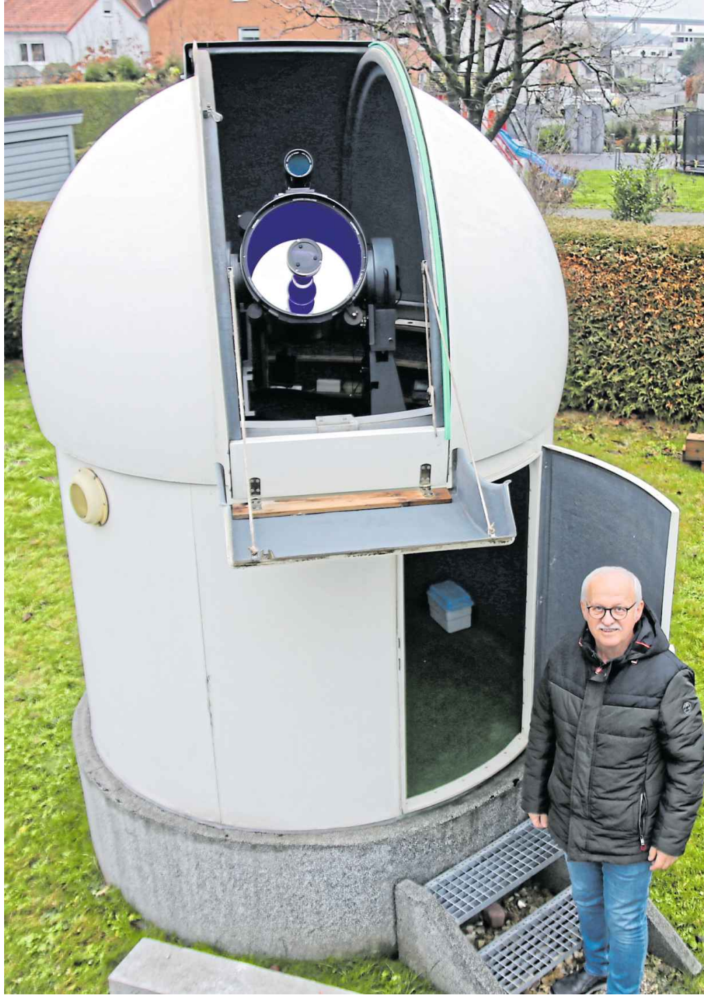
Eberhard Poguntke zeigt seine Gartensternwarte mit umgebauter Encodermontage und einem 40cm Cassegrain Teleskop in der Gemeinde Borcheln im Kreis Paderborn. Foto: Ingo Kalischek
