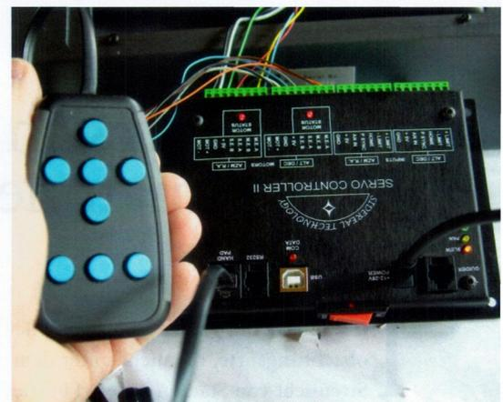
▲ Abb. 4: Der SiTech Servo II Controller mit Handsteuerung Marke Eigenbau.
