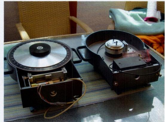
▲ Abb. 3: Das Deklinationsgehäuse mit eingebautem Encoder (rechts) sowie Motor und Getriebe (links).
